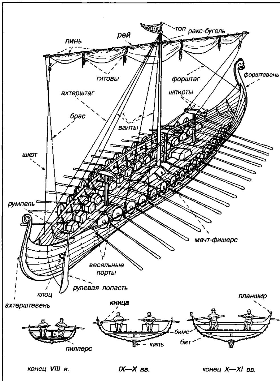
Рис. 25. Обустройство палубы и остнатка скандинавского боевого судна IX—XI вв. Эволюция корабельного шпангоута в «эпоху викингов»
